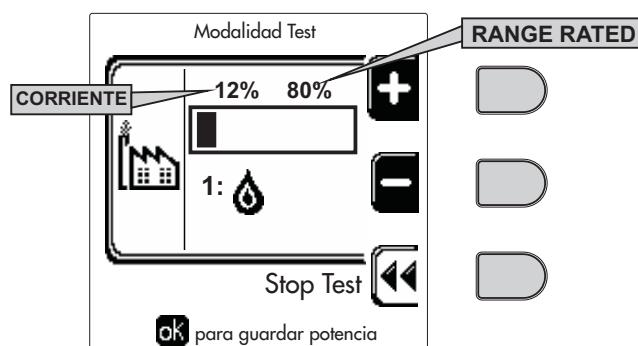
fig. 64 - Modo TEST (ejemplo potencia de calefacción = 80 %)
