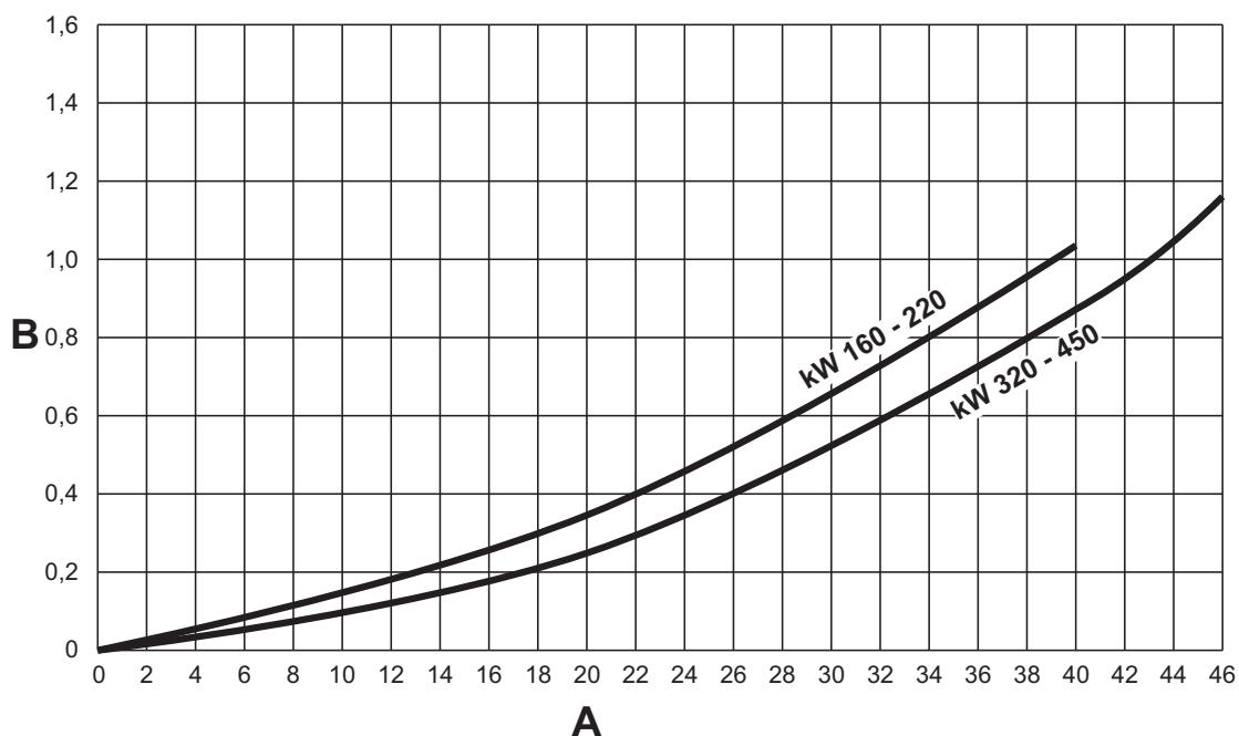
fig. 91 - Diagramma perdita di carico modelli 220, 320 e 450
