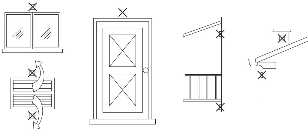
fig. 54- Posición desaconsejada de la sonda exterior
