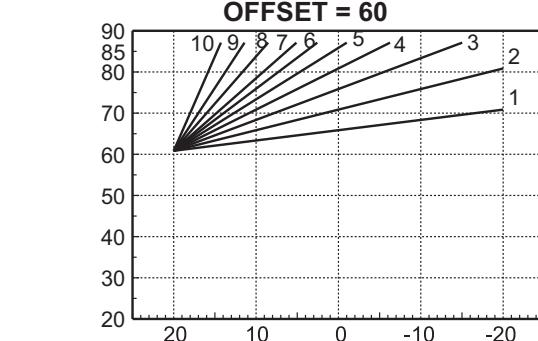
fig. 31- Ejemplo de desplazamiento paralelo de las curvas de compensación
