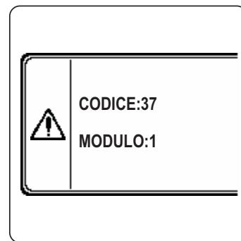
fig. 32 - Anomalia pressione impianto insufficiente Modulo 1
