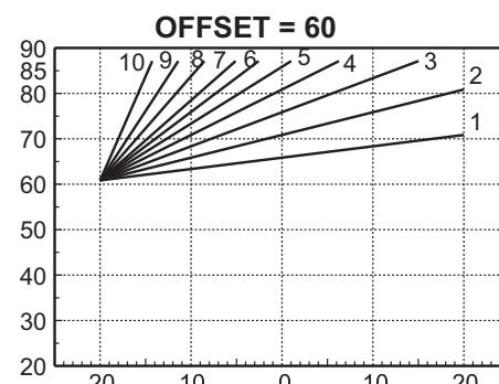
рис. 31- Пример параллельного смещения компенсационных кривых
