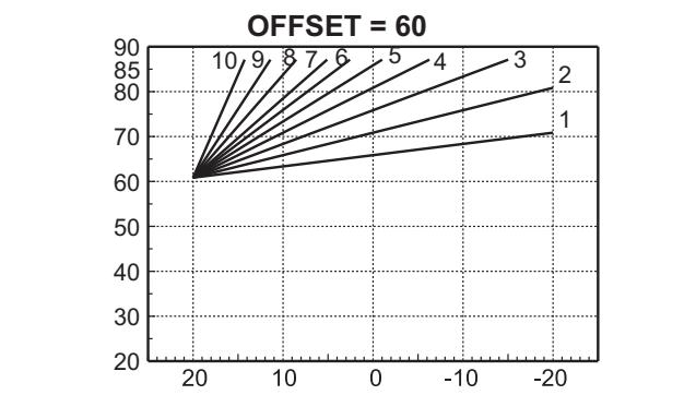
fig. 31 - Esempio di spostamento parallelo delle curve di compensazione
