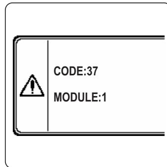
fig. 32- Anomalie de pression insuffisante sur l'installation Module 1
