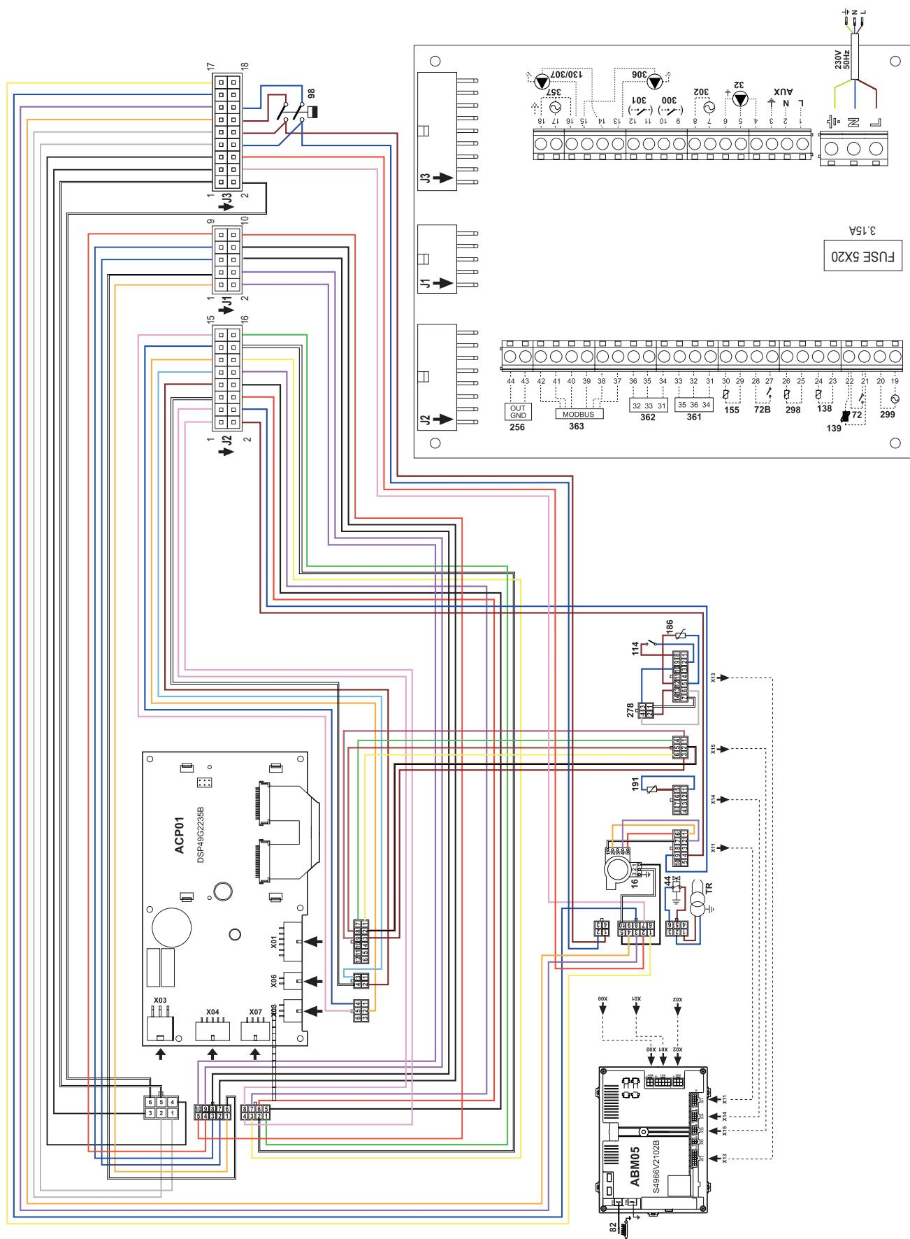
рис. 97- Электрическая схема CLOVER 220/320 и CLOVER 450
