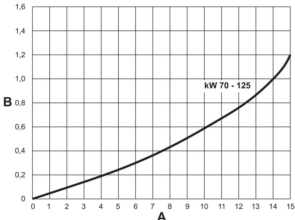
fig. 90 - Diagrama de pérdidas de carga modelos 70 - 125
