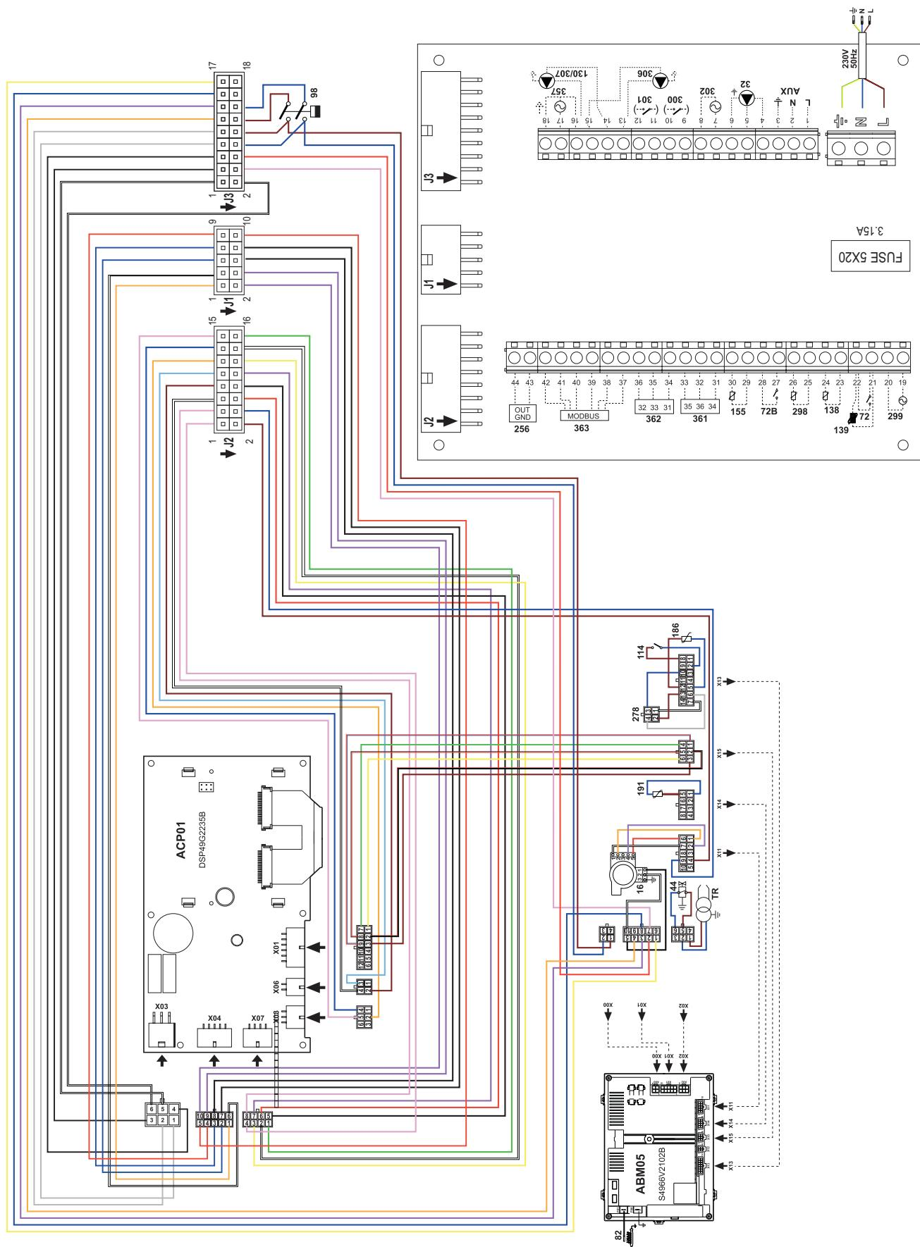
**fig. 97- Wiring diagram CLOVER 220/320 and CLOVER 450**
