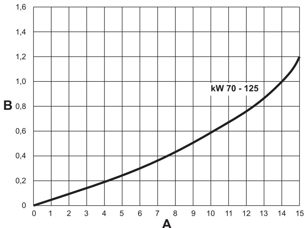
fig. 90 - Diagramme perte de charge modèles 70 - 125
