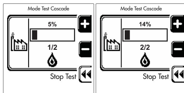
fig. 66 - Mode TEST Cascade (exemple avec deux modules)
