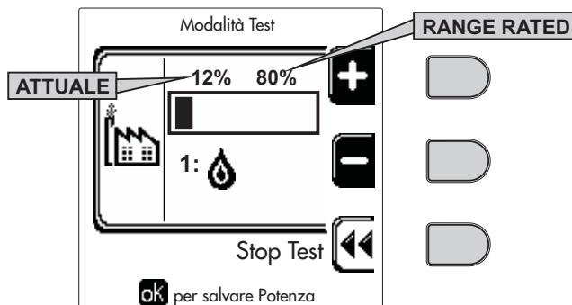
fig. 64 - Modalità TEST (esempio potenza riscaldamento = 80%)
