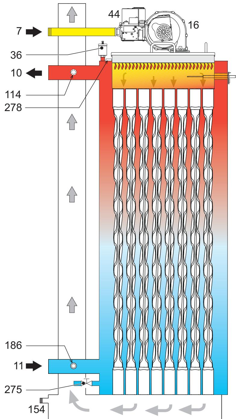
fig. 89 - Circuito idraulico
