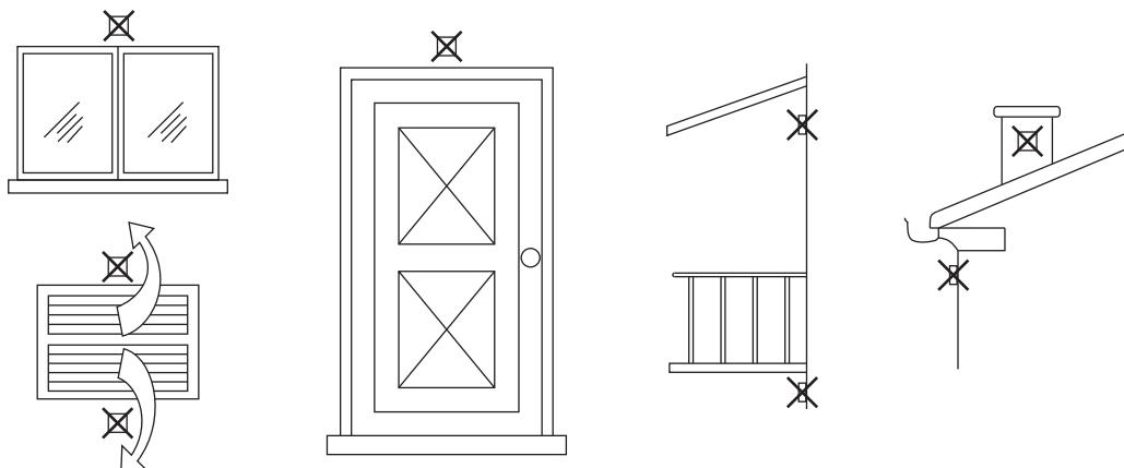
fig. 54- Positionnement déconseillé de la sonde extérieure
