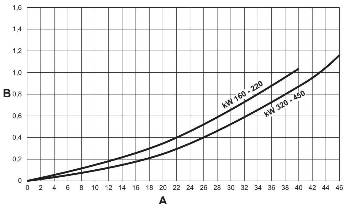
fig. 91 - Diagramme perte de charge modèles 220, 320 et 450
