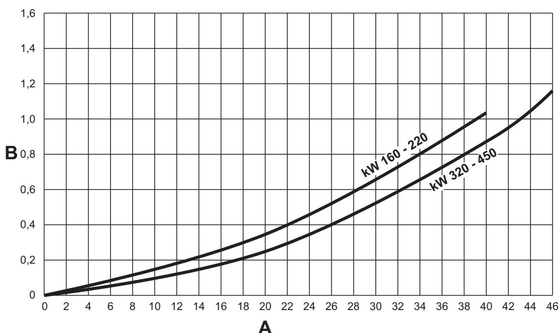
fig. 91 - Diagrama de pérdidas de carga modelos 220, 320 y 450
