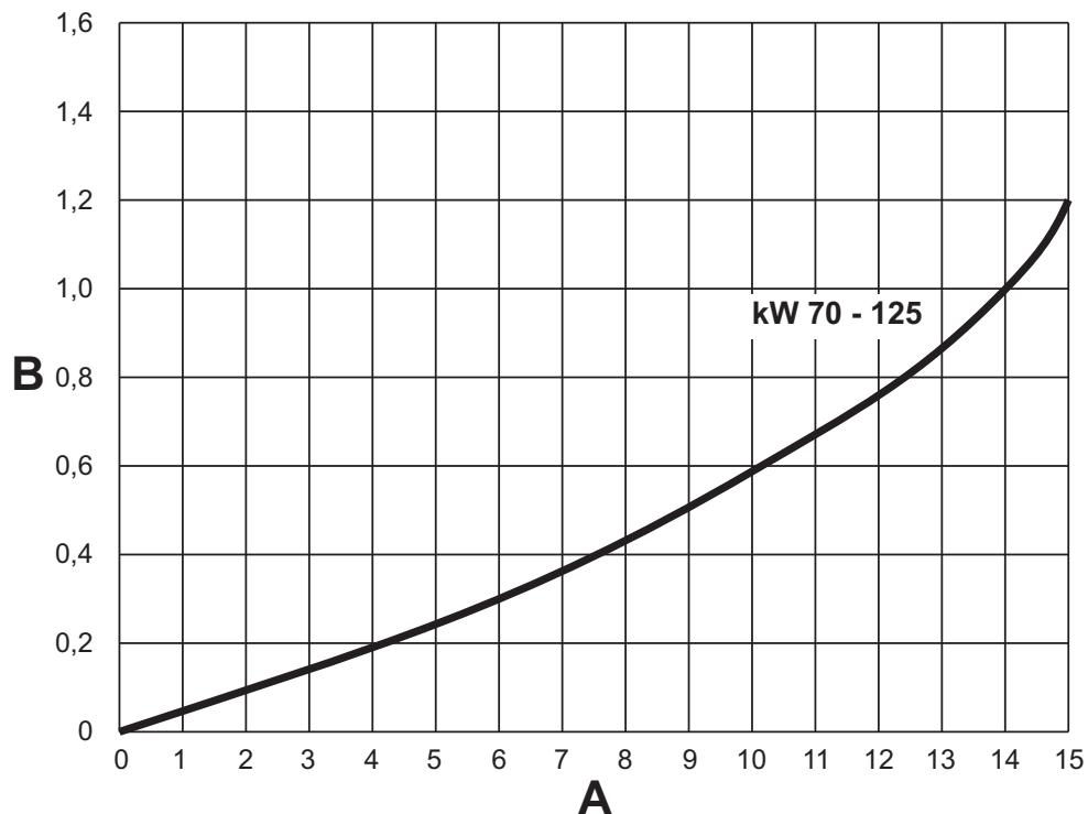
fig. 90 - Diagramma perdita di carico modelli 70 - 125
