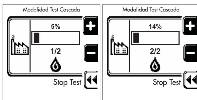
fig. 66 - Modo TEST Cascada (ejemplo do dos módulos)
