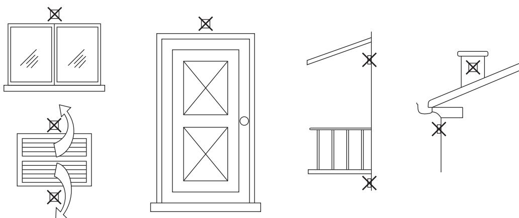
рис. 54- Нежелательное расположение датчика температуры наружного воздуха
