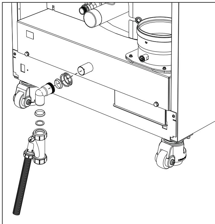
fig. 58- Conexión de la descarga de condensado
