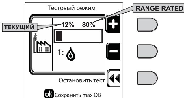
рис. 64 - Тестовый режим TEST (пример: мощность отопления = 80%)
