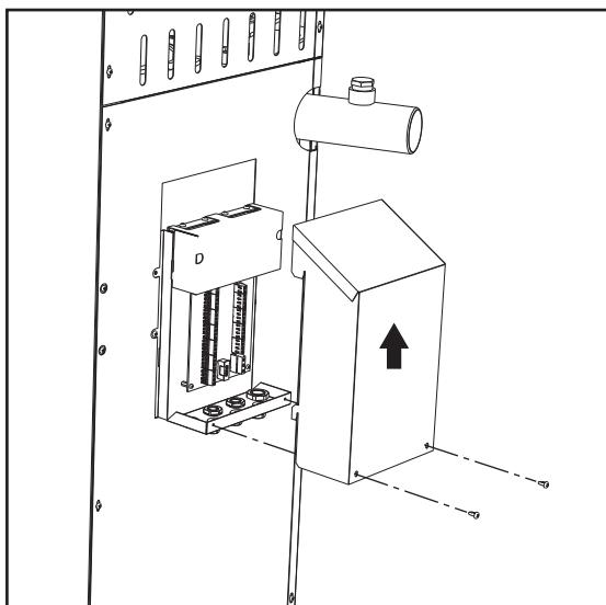
рис. 55- Клеммная колодка
