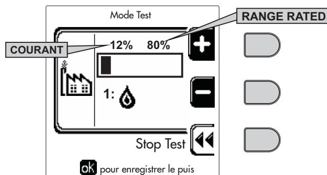
fig. 64 - Mode TEST (exemple puissance chauffage = 80%)
