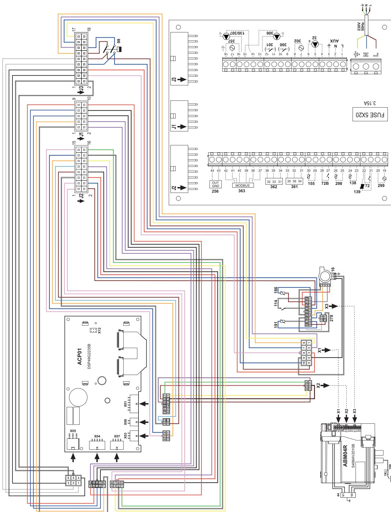
рис. 96- Электрическая схема CLOVER 125 и 160
