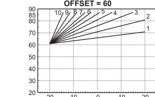
fig. 31- Exemple de déplacement parallèle des courbes de compensation
