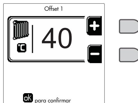
fig. 29- Desplazamiento paralelo de las curvas
