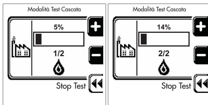
fig. 66 - Modalità TEST Cascata (esempio con due moduli)
